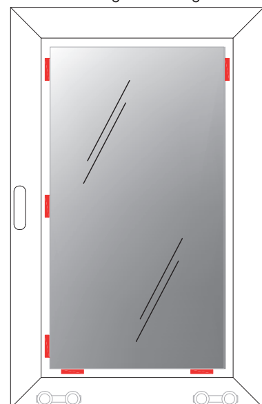
Θέση τοποθέτησης τάκων στον υαλοπίνακα. Location of wedges for the glass sash.
