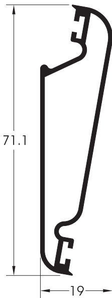
ΚΩΔΙΚΟΣ/CODE Γ148 ΒΑΡΟΣ/WEIGHT 544gr/m ΠΕΡΙΓΡΑΦΗ/DESCRIPTION Προφίλ για κινητή περσίδα Moving louver profile
