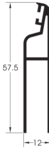
ΚΩΔΙΚΟΣ/CODE Γ149 ΒΑΡΟΣ/WEIGHT 446gr/m ΠΕΡΙΓΡΑΦΗ/DESCRIPTION Τελείωμα για κινητή περσίδα Ending for moving louver
