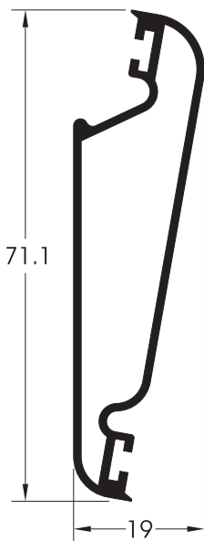
ΚΩΔΙΚΟΣ/CODE Γ148 ΒΑΡΟΣ/WEIGHT 544gr/m ΠΕΡΙΓΡΑΦΗ/DESCRIPTION Προφίλ για κινητή περσίδα Moving louver profile
