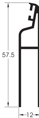
ΚΩΔΙΚΟΣ/CODE ΒΑΡΟΣ/WEIGHT Γ149 446gr/m ΠΕΡΙΓΡΑΦΗ/DESCRIPTION Τελείωμα για κινητή περσίδα Ending for moving louver
