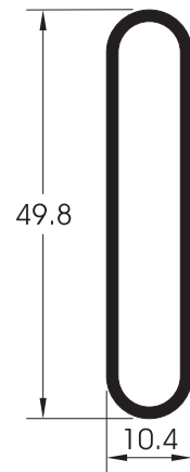
ΚΩΔΙΚΟΣ/CODE ΒΑΡΟΣ/WEIGHT Γ480 405gr/m ΠΕΡΙΓΡΑΦΗ/DESCRIPTION Οβαλίνα για σταθερή περσίδα Oval profile for fixed louver
