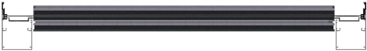
Εικόνα 13: Φέρνουμε τα πλαίσια σε ευθεία και βιδώνουμε ξανά τη «γλύστρα»
