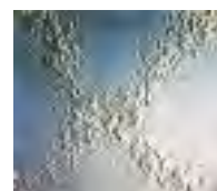
Προχωρημένη νηματοιειδής διάβρωση σε ηλεκτροστατικά βαμμένη επιφάνεια αλουμινίου
