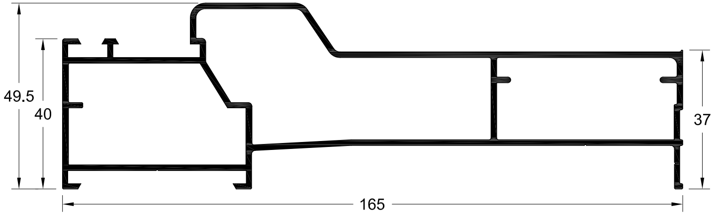
TV5 567 ΚΑΣΑ ΔΙΧΡΩΜΙΑΣ ΓΙΑ ΤΟΠΟΘΕΤΗΣΗ ΣΗΤΑΣ ΚΑΙ ΚΙΝΗΤΗΣ ΠΕΡΙΣΙΔΑΣ 2.097 gr/m FRAME FOR TWO COLOR COMBINATION WITH INSECT SCREEN AND MOVABLE LOUVER
