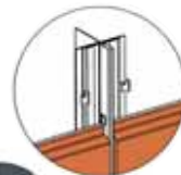
Κλειστός αρμός Fuge πλάτους 9mm
