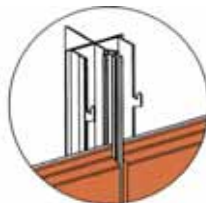
Προφίλ αρμού από νεοπρένιο CLS σε κάθετο αρχικό υπόστρωμα
