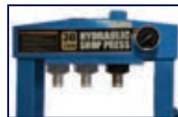
Μετακίνηση εμβόλου δεξιά-αριστερά
