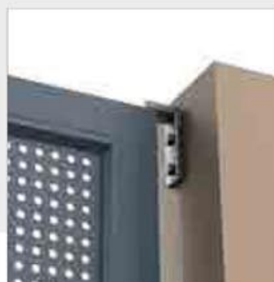
Εξωτερικός ανοξείδωτος μεντεσές στήριξης με δυνατότητα ρύθμισης +/-2mm
